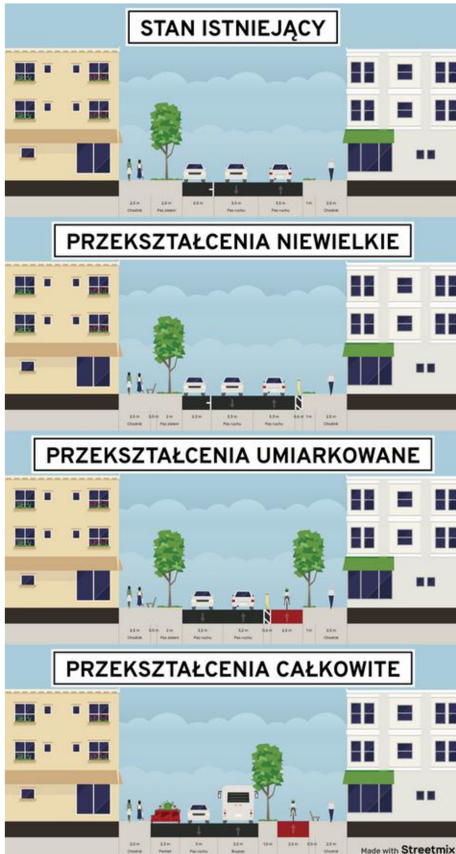
Rys. 7.8 Przykłady poszczególnych stopni przekształceń Źródło: opracowanie własne za pomocą Streetmix
